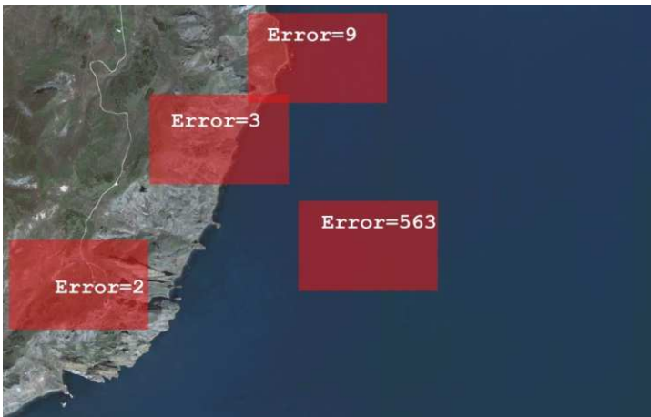
Рис. 5. Влияние наличия моря в рабочем кадре на погрешность фазово-корреляционного алгоритма
