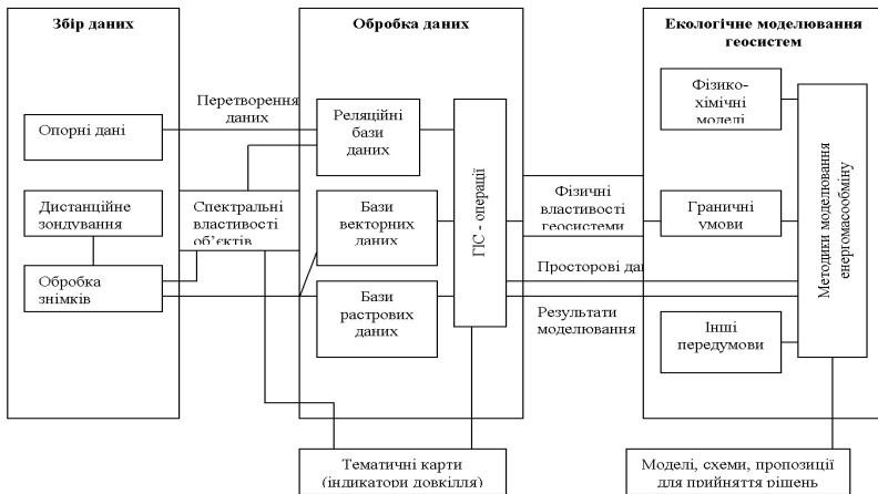
Рис. 1. Технологічна схема використання оперативних космічних знімків у складі ГІС ОНПС
